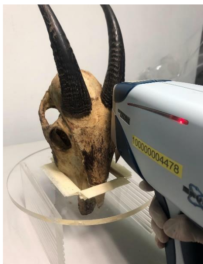
ภาพที่ 2 ภาพแสดงวิธีการทดลองด้วยการสแกนตัวอย่าง ด้วยเครื่องเอกซเรย์ฟลูออเรสเซนซ์แบบพกพา
